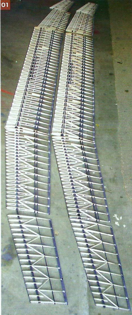
band auf dem Baubrett fixiert, daran wird die Vorderkante der Endleiste ausgerichtet. Nicht vergessen das Baubrett und Lineal mit Plastikfolie abzudecken damit nichts anklebt. Der Kohlefaser-schlauch wird nun über die Endleiste gezogen, mit Harz getränkt und am Lineal angelegt. Die hinter-
