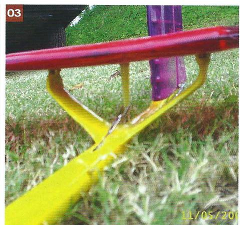
**01-03** Der Bau des Höhenleitwerkpylons: In einer Form aus Styropor werden die Einzelteile winkeltreu verklebt, mit GFK beschichtet und schließlich auf dem Rumpf montiert. Als Pendelscharniere können herkömmliche, teilbare Ruderscharniere verwendet werden
