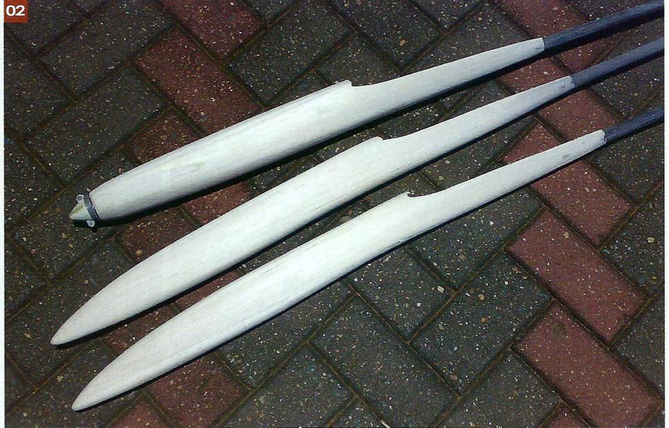
**01** Sieht schlimmer aus als es ist, der tatsächliche Bau der Tragfläche geht recht schnell von der Hand. Da kann man auch gleich zwei bauen **02** Die Rumpfe werden aus dickem Material herausgeschliffen, der Leitwerksträger ist ein Kohlerohr
