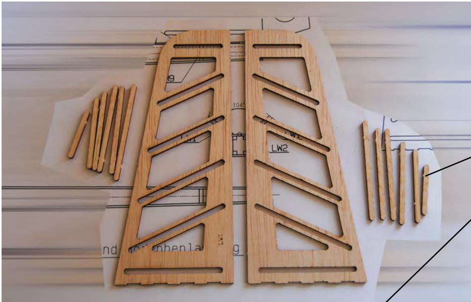
**Kleben Sie mit dünnflüssigem CA die Einleger in die dafür vorgesehenen Schlitz in den Leitwerksflossen.**
