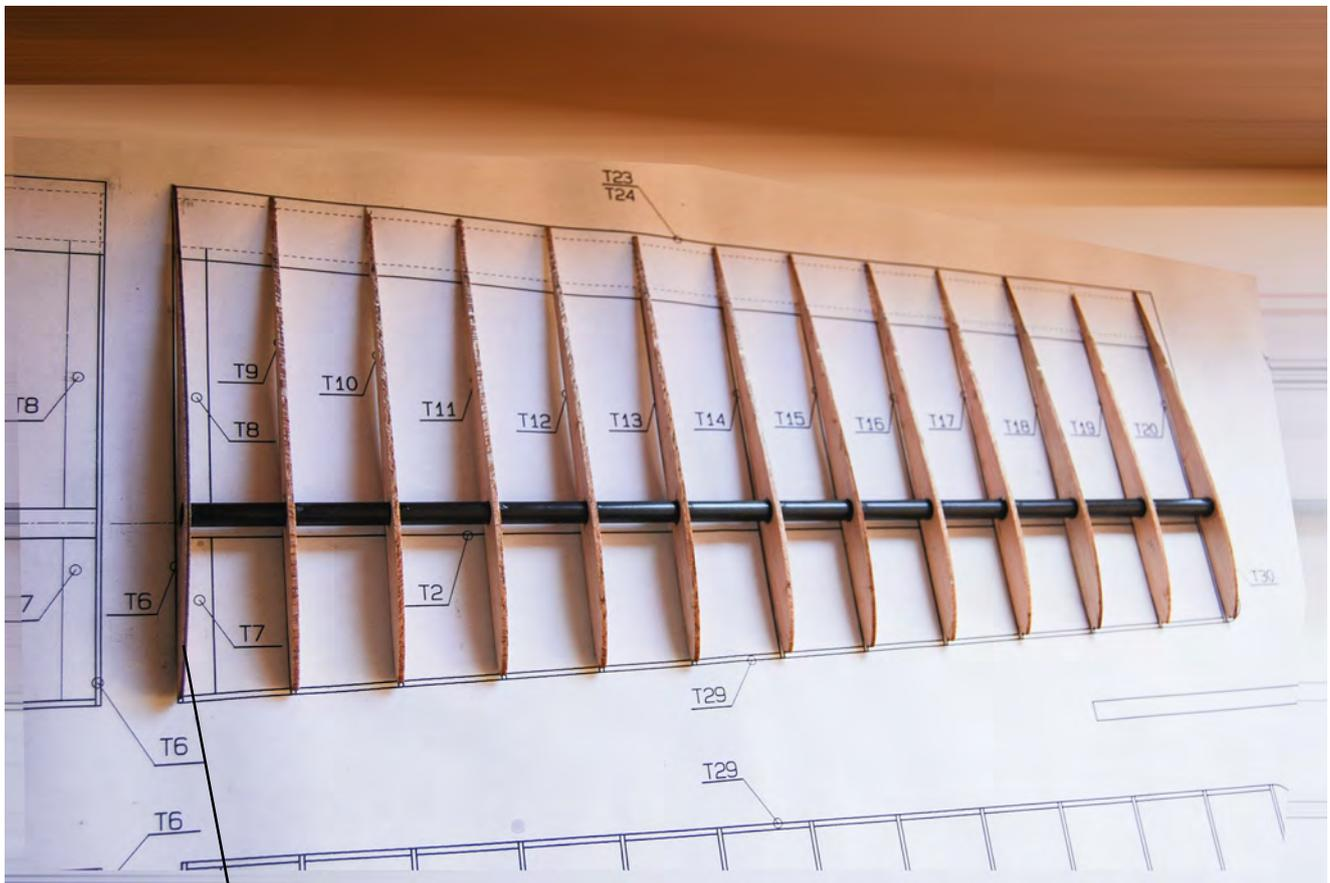
Die Herstellung des äußeren Tragflächensegmentes erfolgt in gleicher Weise wie das innere Segment: Ausrichtung und Verklebung der Rippen laut Plan, Schrägstellung der Sperrholzrippe T6, Verklebung der Nasenleiste und Anbringung der Verstärkungsteile T7+T8.
