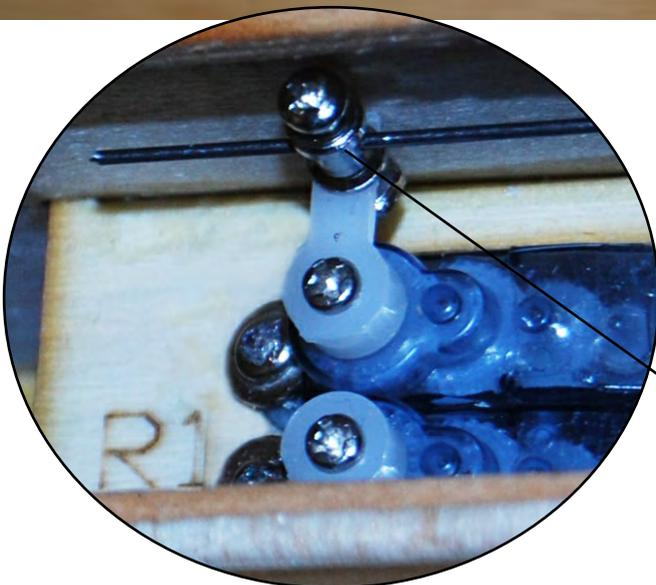
Befestigen Sie an den Servohebeln die mitgelieferten Verschraubungen für den Anlenkungsdraht wie abgebildet.
