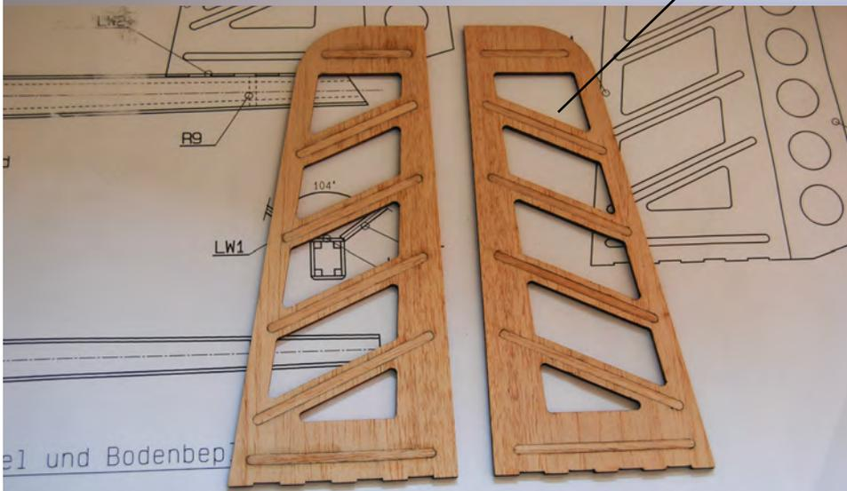
**Die Folierung der Leitwerke kann je nach Geschmack auch jetzt schon erfolgen. Hierbei müssen Sie nur aufpassen, dass Sie nicht bis ganz an die untere Kante folieren, damit noch eine kleine Klebefläche freibleibt. Das Leitwerksmittelstück (siehe nächste Seite) kann später mit einem schmalen Streifen Folie bebügelt werden.**
