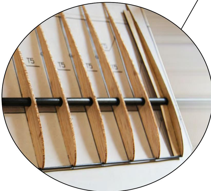
Jetzt folgt die Verklebung der oberen Endleiste T22 an den Rippenenden.
