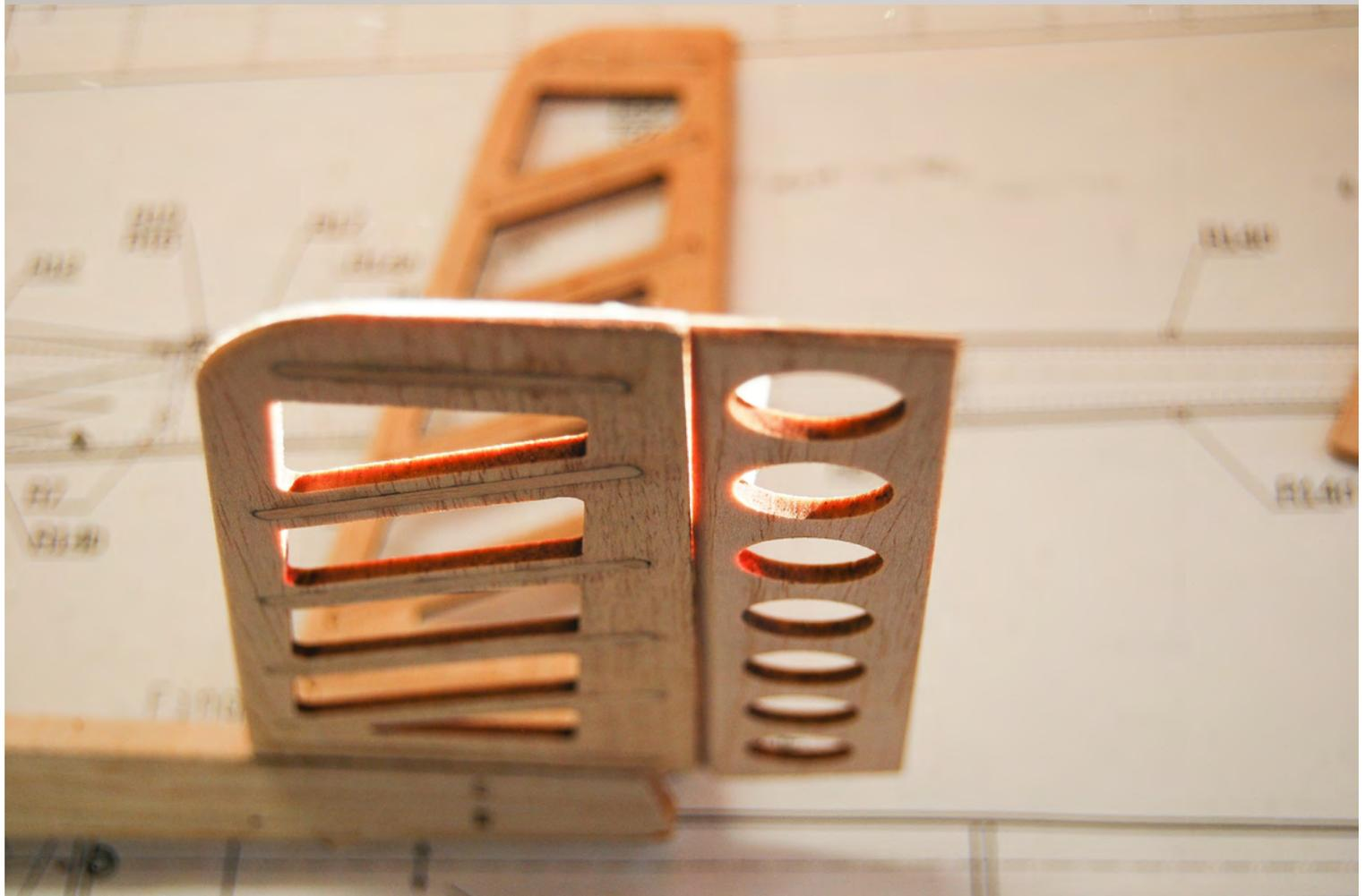
Die Ruderhörner werden wie abgebildet in die Anlenkungsdrähte eingehängt und auf die Ruder aufgeklebt. Schleifen Sie die Seite der Ruder wo die Ruderhörner angeklebt werden schräg an, um eine größere Klebefläche zu erhalten. Die Ruder können Sie zum Folieren (nach Entfernen des Tesafilms) aushängen. Ebenso wie beim Leitwerk können Sie die Ruder schon vorher mit Folie bespannen und die Ruderhörner danach ankleben.
