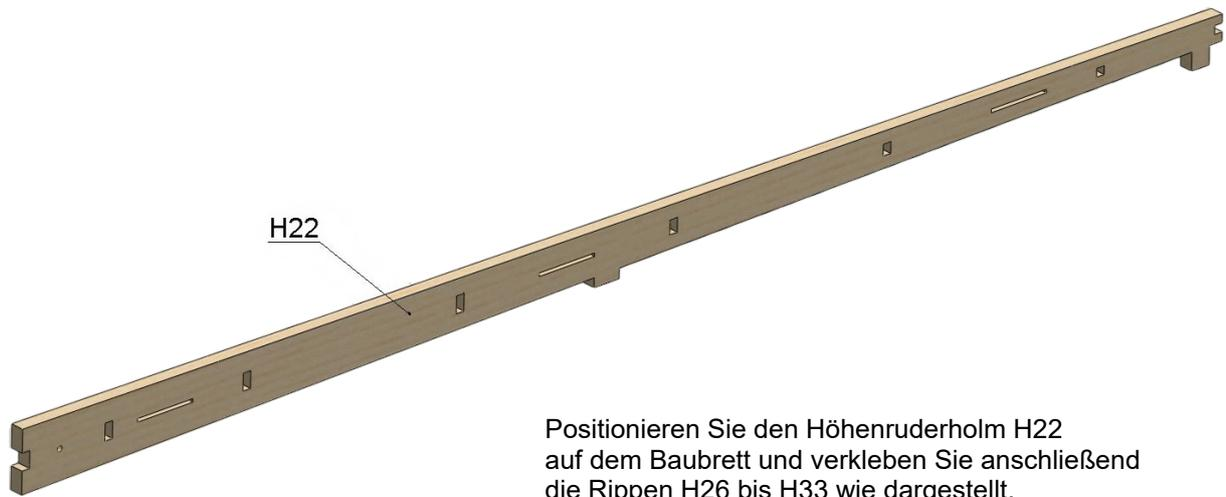
Positionieren Sie den Höhenruderholm H22 auf dem Baubrett und verkleben Sie anschließend die Rippen H26 bis H33 wie dargestellt.
