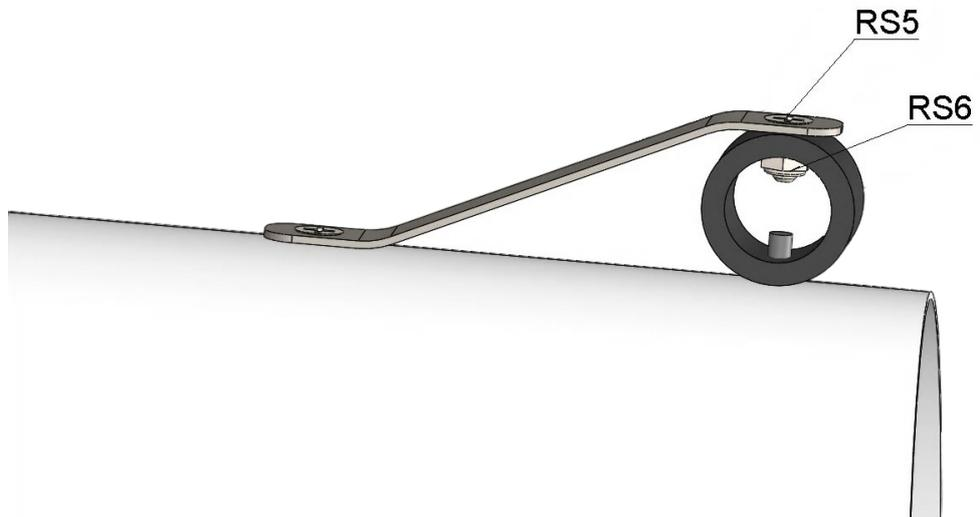
Anschließend wird die M3-Senkschraube durch die Lasche und den Dämpfer gesteckt und mit der M3-Sicherungsmutter angeschraubt.
