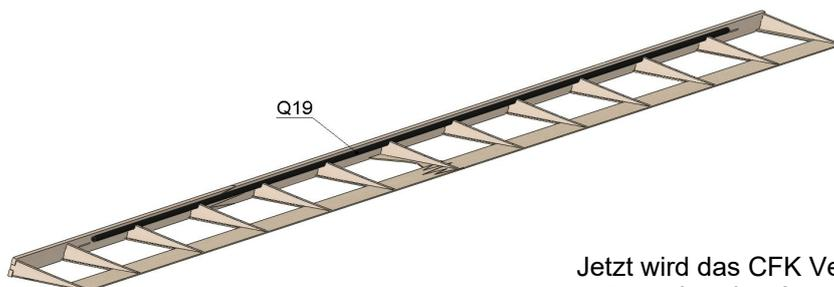
Jetzt wird das CFK Verstärkungsrohr Q19 in die entsprechenden Ausnehmungen der Rippen geklebt.
