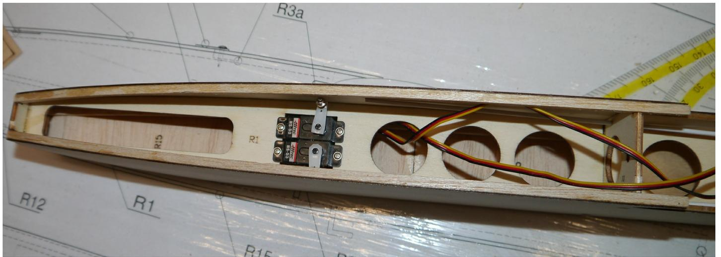
Nun wird der vordere Bereich der Oberseite beplankt. Beachten Sie bitte den Bauschritt auf der nächsten Seite, da in diesem Bereich auch die Wartungsklappe hergestellt wird!
