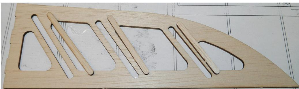
In den Leitwerksteilen werden nun die Verstärkungsleisten eingeklebt.
