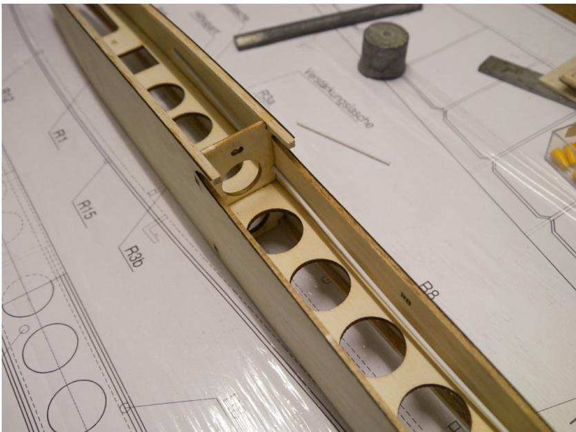
Danach werden die Verstärkungsteile R8 in den Rumpf eingeklebt.
