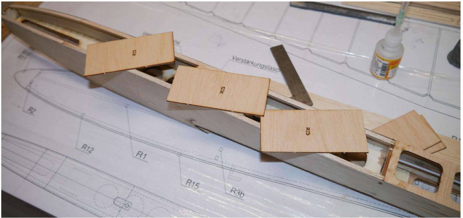
Nun wird der vordere Bereich der Unterseite mit den Teilen R15 beplankt.
