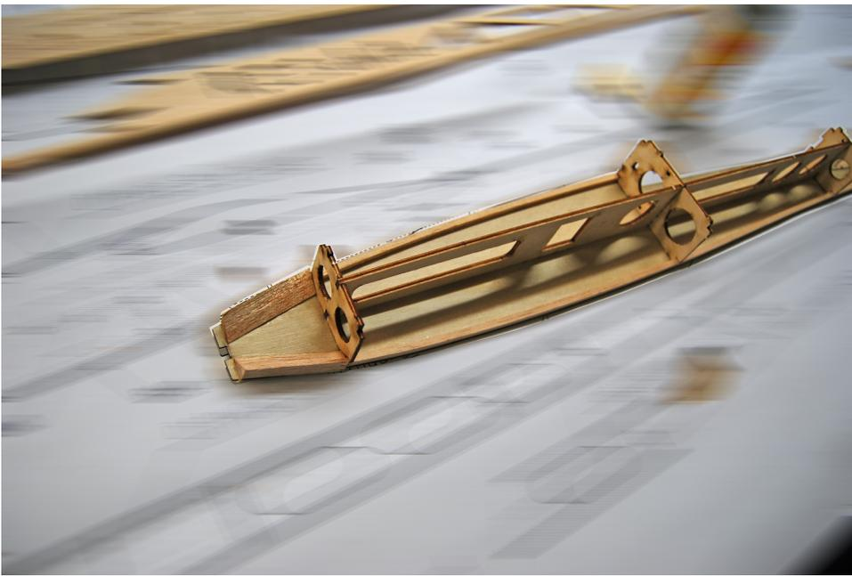
Nun werden im vorderen Segment die 10x10mm Dreikantleisten wie dargestellt aufgeklebt. Vorne bleibt ein Absatz von 3mm für den Motorspant!
