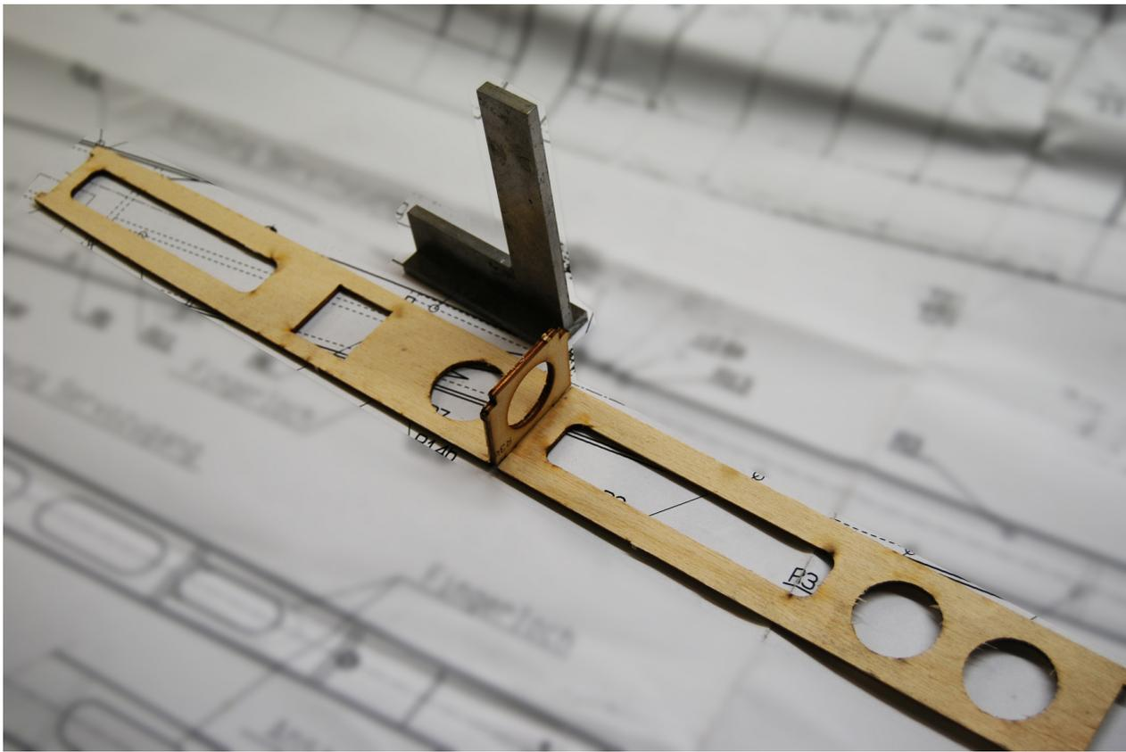
Nun wird der Längsspant R1 auf das Baubrett gelegt, der Spant R3a rechtwinklig aufgesteckt und verklebt.
