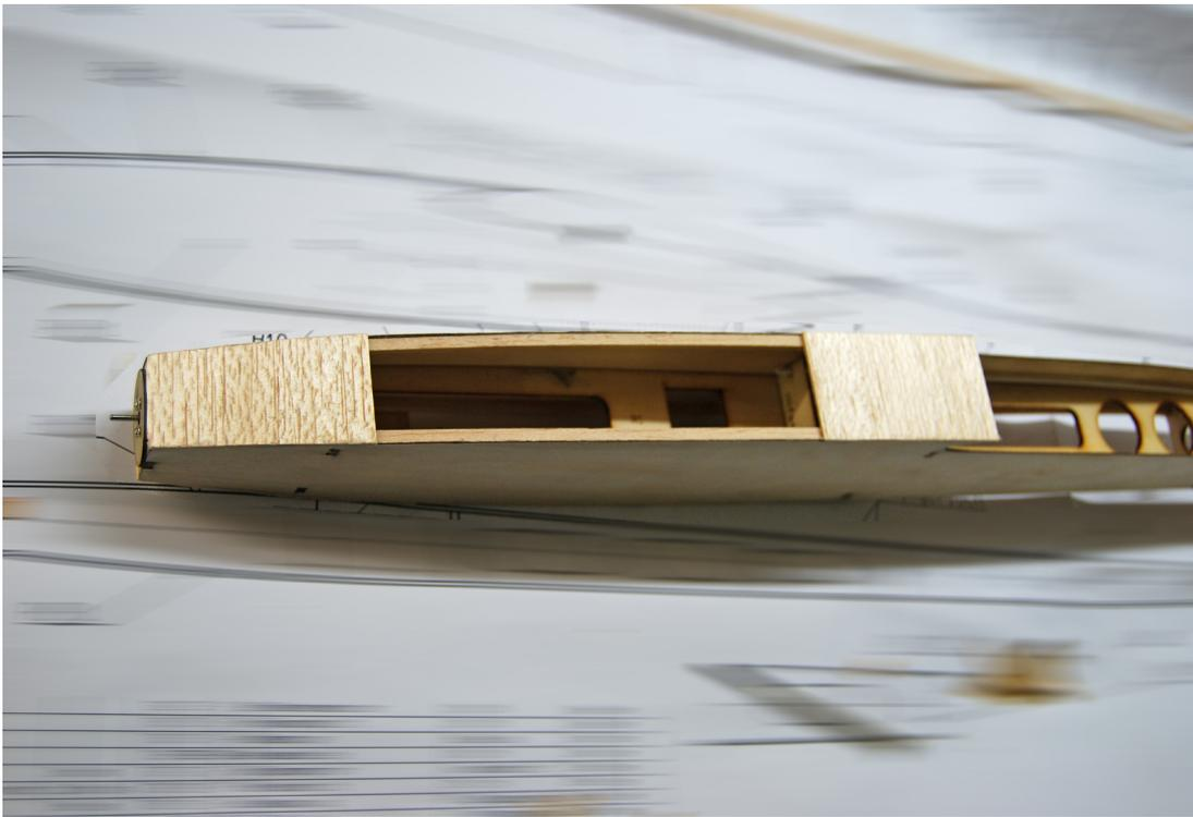
Danach werden die Dreikantleisten mit der Rumpfkontur verschliffen und wie dargestellt, die obere Beplankung hergestellt. Der freie Bereich ist für die Wartungsklappe bestimmt.
