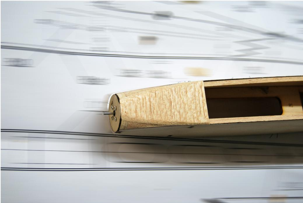
Im Anschluss wird die Schnauze wie dargestellt rundgeschliffen, genau auf den Durchmesser des Motorspantes.
