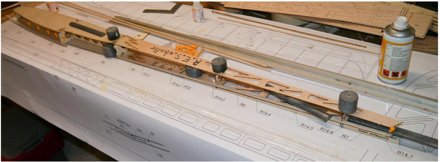
Danach wird der zweite Seitenteil auf das Gerippe gesteckt und verklebt. Damit der Seitenteil richtig sitzt, wird auch dieser während der Trocknung beschwert.
