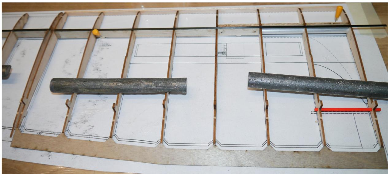
Nun wird die Beplankung T40 an der Tragfläche angebracht und im Anschluß der Klappenrahmen welcher aus den Teilen T26 und T27 besteht (siehe auch Bauplan). Danach den Beplankungsteil T33 verkleben.
