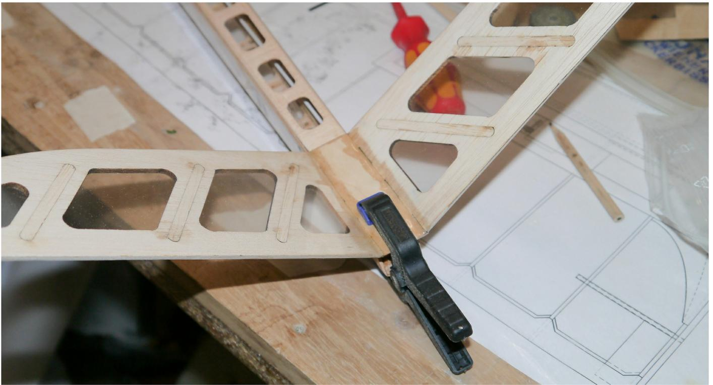
Im nächsten Schritt wird das Leitwerk wie gezeigt auf den Rumpf geklebt. Hier kann in die entstehende Kante eine Kleberraupe gelegt werden, für eine kraftschlüssige Verbindung des Leitwerkes zum Rumpf.
