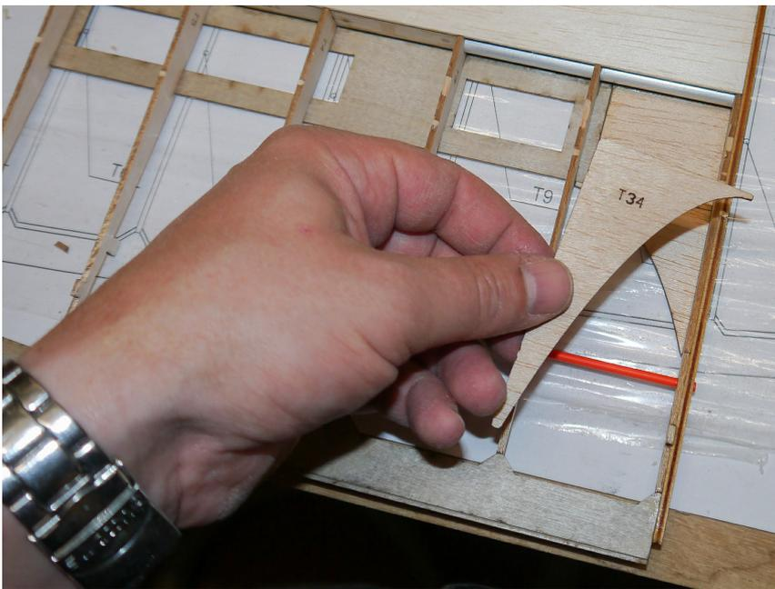
Danach wird wie dargestellt der Beplankungsteil T34 an der Tragfläche angebracht.
