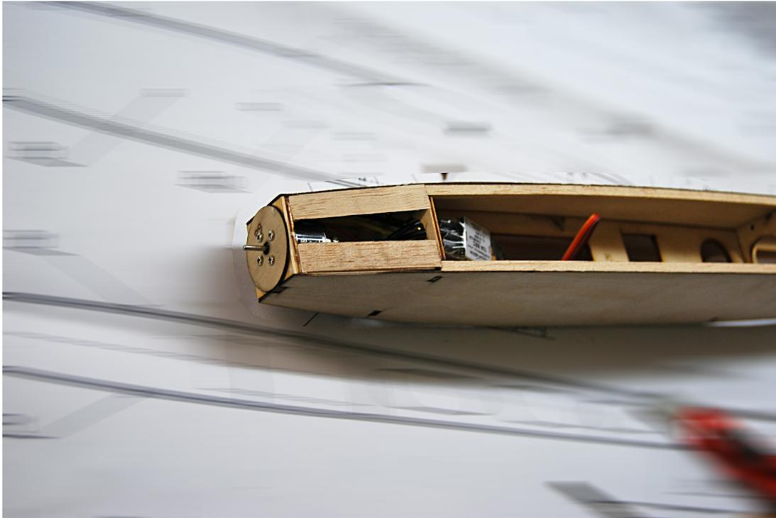
Jetzt wird der Motor von vorne in den Rumpf geschoben und der runde Motorträger R9 mit dem Motorspant R2 verklebt. Richten Sie den Motorträger R9 an dem eingelaserten Kreis auf dem Motorspant R2 aus.
