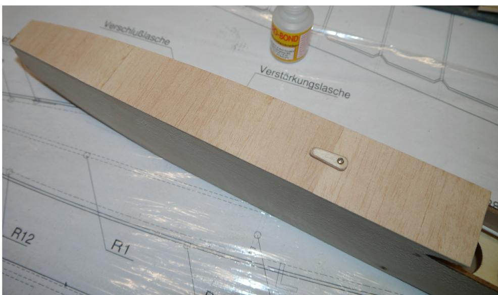
An der Hinterseite des Ausschnittes wird eine Verschlusslasche aufgeschraubt (siehe Bild). Hierzu kleben Sie an die Innenseite der Beplankung ein Stück Sperrholz für den festen Sitz der Schraube. Die Verschlusslasche liegt als Laserteil dem Bausatz bei.
