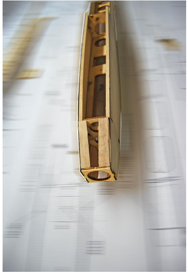
Nun werden die Dreikantleisten auf die zweite Rumpffseite geklebt. Im Anschluß wird der Motorspant R2 eingeklebt.
