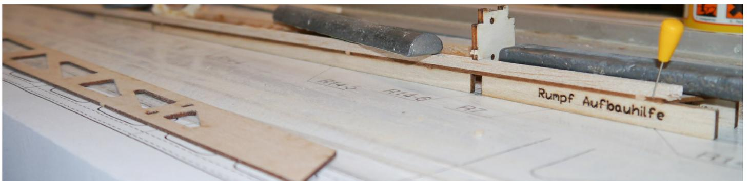
Jetzt wird die Rumpf Aufbauhilfe unter dem Seitenteil platziert und der Seitenteil so beschwert, dass dieser satt auf der Aufbauhilfe aufliegt. Die Markierungen müssen sich genau unterhalb der jeweiligen Spanten befinden.
